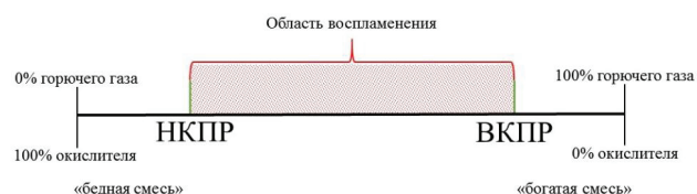
Рис. 2. Схема связи области воспламенения с НКПР и ВКПР
